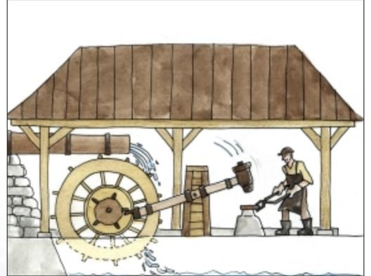
Schmiedehammer: Das Wasserrad drückte über Noppen den hinteren Teil des Hammers herunter, so dass sich der vordere anhob und dann durch sein Gewicht wieder herunterfiel
