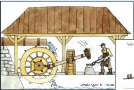
Hammerwerk – Funktion: Die „Daumen“ (Nocken) auf dem Baum des Mühlrades drücken den „Schwanz“ des Eisenhammers hinten herab, so daß sich der Hammerkopf vorne hebt. Durch die Schwerkraft fällt er wieder herab.
