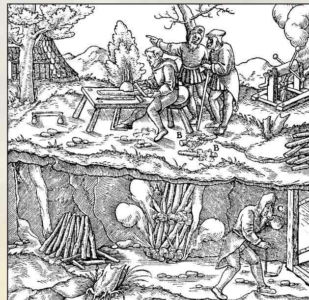
Feuer setzen – um das Gestein zu sprengen
