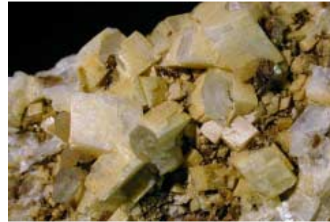
Siderit xx mit Quarz xx und Ankerit xx Eisencarbonat Bildet selten tafelig erhaltene Kristalle, sehr oft zersetzte Aggregate
