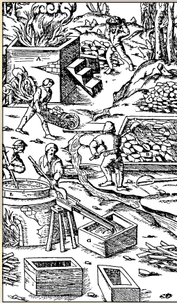
Dem Alaungestein wurde nötigenfalls durch Rösten im Ofen (A) Schwefel herausgetrieben. Das aussortierte Gestein für die Vitriol-, oder je nachdem zur Alaunherstellung warf man auf die Laugenbühne (B) und übergoss es gelegentlich mit Wasser. Später ist dann die wässrige Lösung im Kessel (E) eingedickt und in der Wanne (G) geklärt worden. Text Falkenstein.
