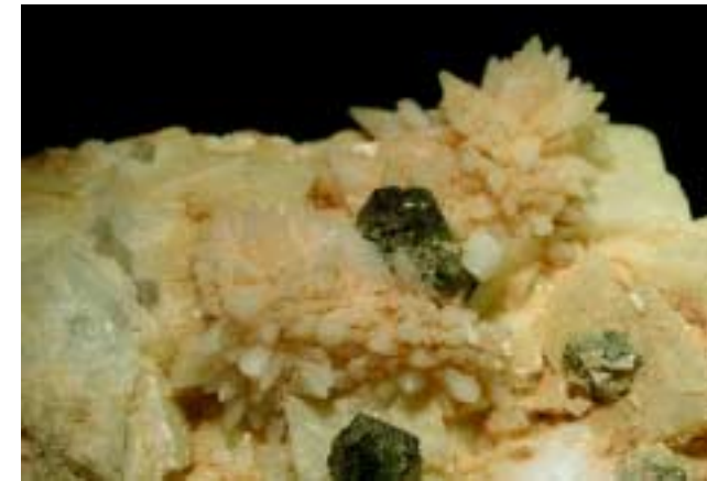
Pyrit xx auf Calcit xx und Dolomit xx Eisensulfid mit Calciumcarbonat Selten in so guter Ausbildung, derb sehr verbreitet
