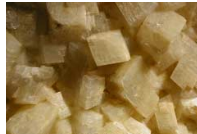
Ankerit xx Calcium-Eisen-Carbonat Häufige Spaltenfüllung im Steinbruch, bildet Mischkristalle zu Dolomit
