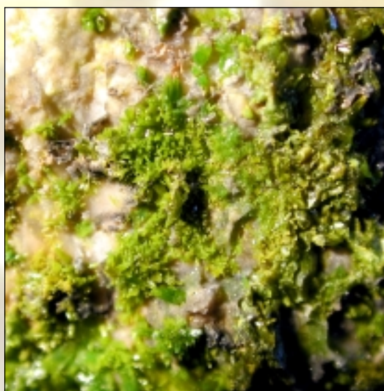
Pyromorphit \text{Pb}_5(\text{PO}_4)_3\text{Cl} : Grünbleierz.
