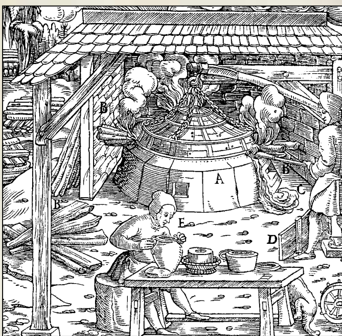
Treibofen – die Reichbleischmelze oxydiert an der Oberfläche unter Luftzufuhr. Das Silber sammelt sich unten als „Silberblick“
