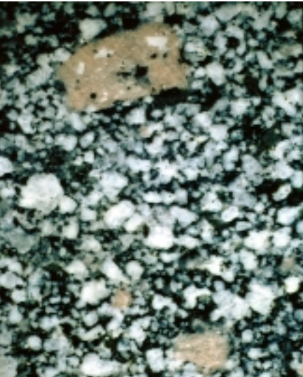
Wehra-Wiesetal-Diatexit , ein durch Aufschmelzung von Gneis gebildeter, fast ausgereifter Granit . Ein etwa 8 cm breiter Anschliff. Orthoklas (hellrosa, nur unvollkommen gestaltete Kristalle), Plagioklas (weiß), Quarz (hellgrau) und Biotit (schwarz). Bild: Wimmenauer.
