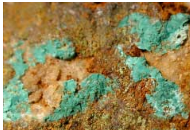
Malachit x Kupfercarbonat Dünne Anflüge in Spalten des Aplites
