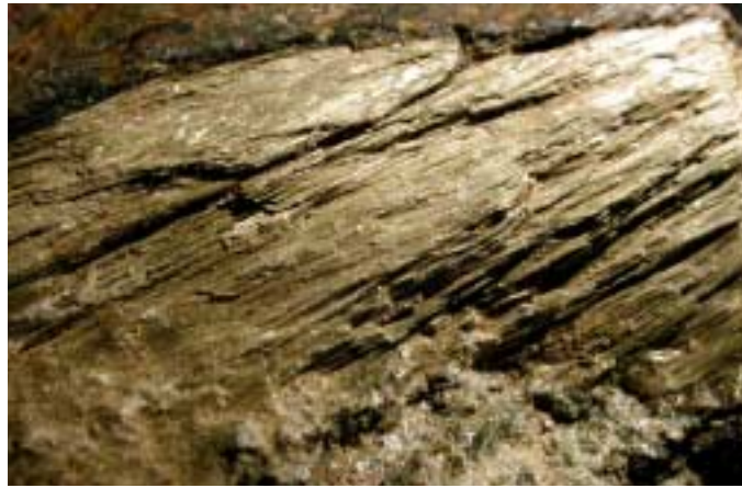
Asbest Magnesiumsilikat Seltenes Mineral in Gneis und Serpentiniten
