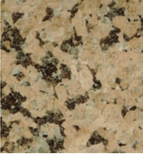
Bärhaldegranit , etwa 8 cm breiter Anschliff. Feldspäte (Ortoklas und Plagioklas) rötlich. Quarz (weißlich bis hellgrau) und Glimmer (dunkel). Bild: Wimmenauer.
