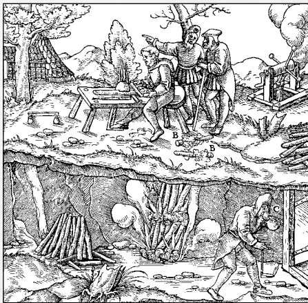
Feuer setzen – um das Gestein zu sprengen
