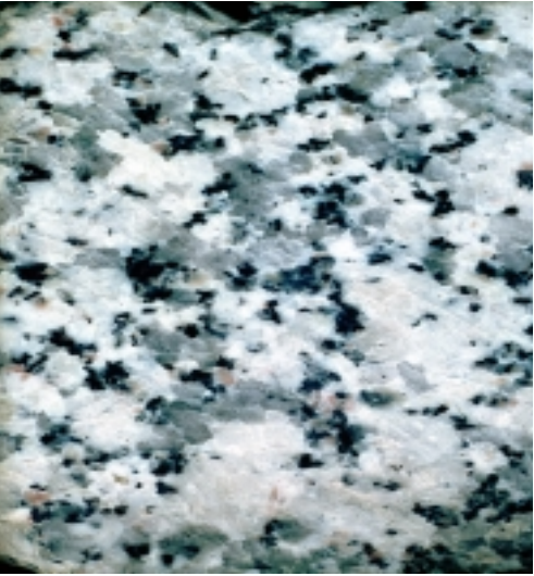
Schluchseegranit , etwa 8 cm breiter Anschliff. Grobkörniges Gefüge aus Orthoklas (ganz blass rötlich), Plagioklas (weiß), Quarz (hellgrau) und Biotit (schwarz). Bild: Wimmenauer.
