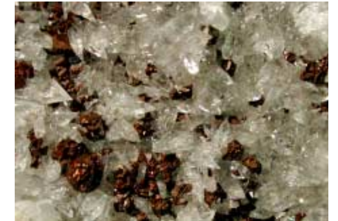
Pyrit xx mit Calcit xx Eisensulfid mit Calciumcarbonat In dieser Ausbildung relativ häufig
