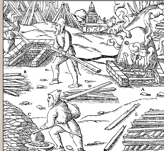
Erz-Rösten zum Schwefel austreiben. Schmelzen und Sauerstoff-Reduzieren zu „Reichblei“
