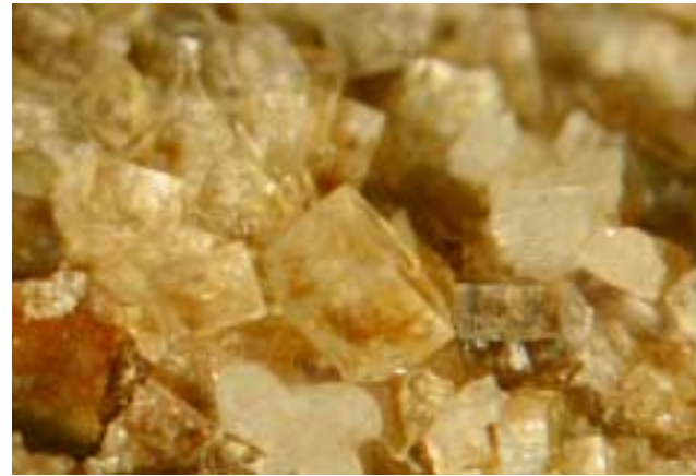
Cerrusit xx auf Fluorit Bleicarbonat Sekundärmineral bei der Verwitterung von Galenit (Bleiglanz)
